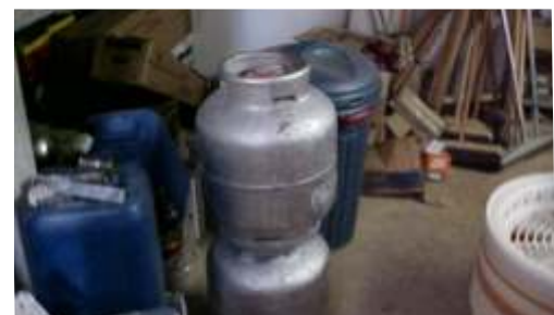
Perigo: botijões de Gás ao lado de materiais inflamáveis (tinner e tinta)
